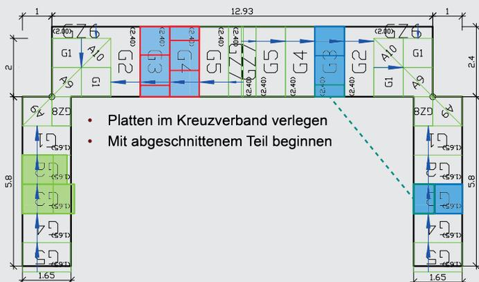
Unsere farbliche Plattenkennzeichnung ermöglicht bei Bauvorhaben mit mehreren Dachflächen eine schnelle und genaue Zuordnung der entsprechend benötigten Platten je Fläche. Bei der Grunddämmung werden die Abschnitte der 1m x 1m Platten wieder an den Anfang der nächsten Reihe angelegt. Dadurch entsteht ein Versatz der Stöße.
